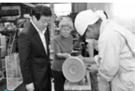
アクリルの透明度を高めるため何度も研磨します
