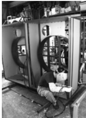
■せんべい製造の現場を支える様々な機器を製作。右はせんべい生地の型抜きに使う部品、左は生地の乾燥機。
