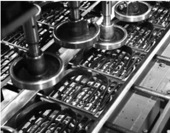
■二連式押し焼き機。手前の網に入った生地は、下の電熱で焼き上げられ、上の金属製押し瓦で押された後、反転し次の網に移動します。
