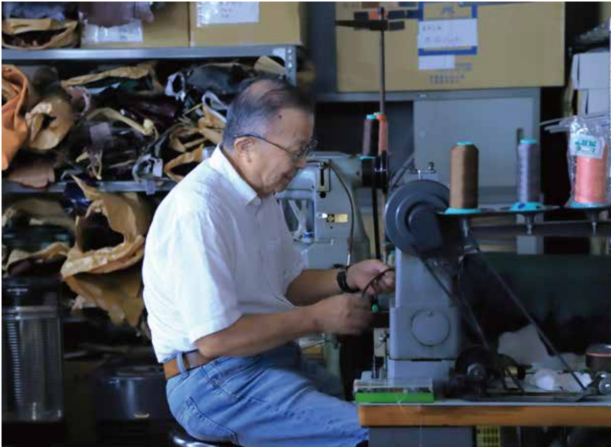
革を縫い合わせる作業には、繊細な技術と集中力が求められる。自然につなげ、美しく仕上げるには、一つのズレも許されない。革の厚みや硬さにも細かく気を配り、微調整しながら丁寧に縫い進めていく
