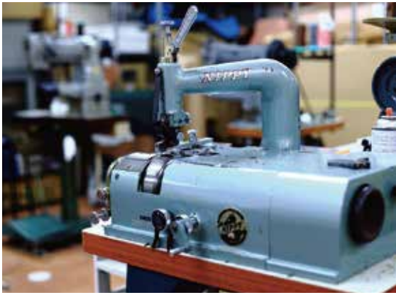
革を薄くすくための専用工具。部分的に厚さを調整する工程は、製品の完成度を高め、心地よい質感を表現するために欠かせない
