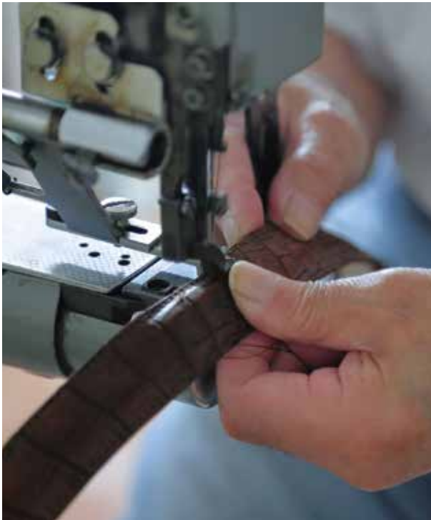
革を縫い合わせる作業には、繊細な技術と集中力が求められる。自然につなげ、美しく仕上げるには、一つのズレも許されない。革の厚みや硬さにも細かく気を配り、微調整しながら丁寧に縫い進めていく
