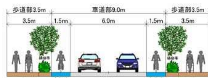
○西町高砂線 幅員構成イメージ W=16m
