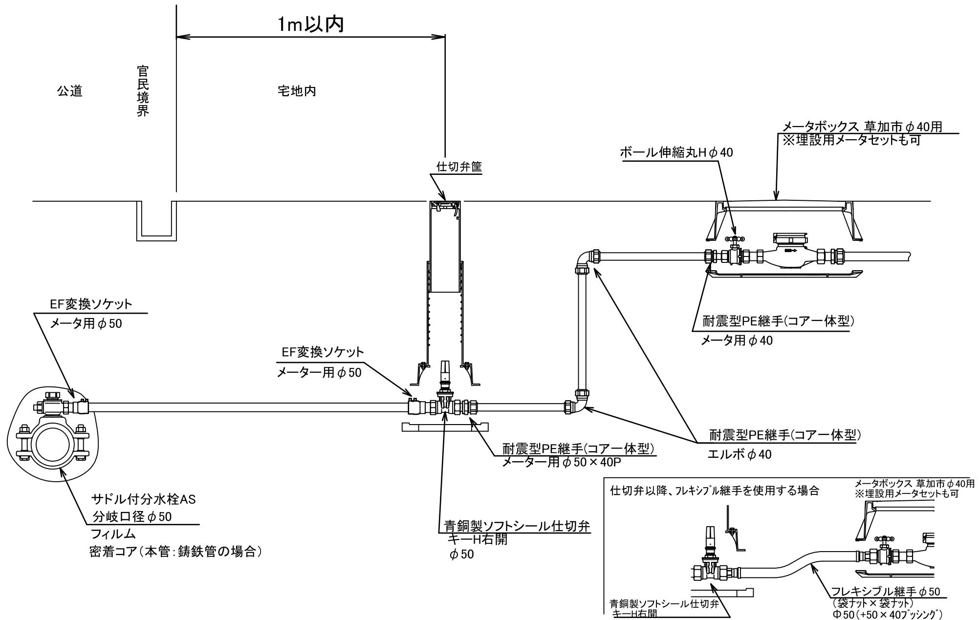
④ 本管: 鋳鉄管・HPPE 引込み口径:  $\Phi 50$  メータ口径:  $\Phi 50$
