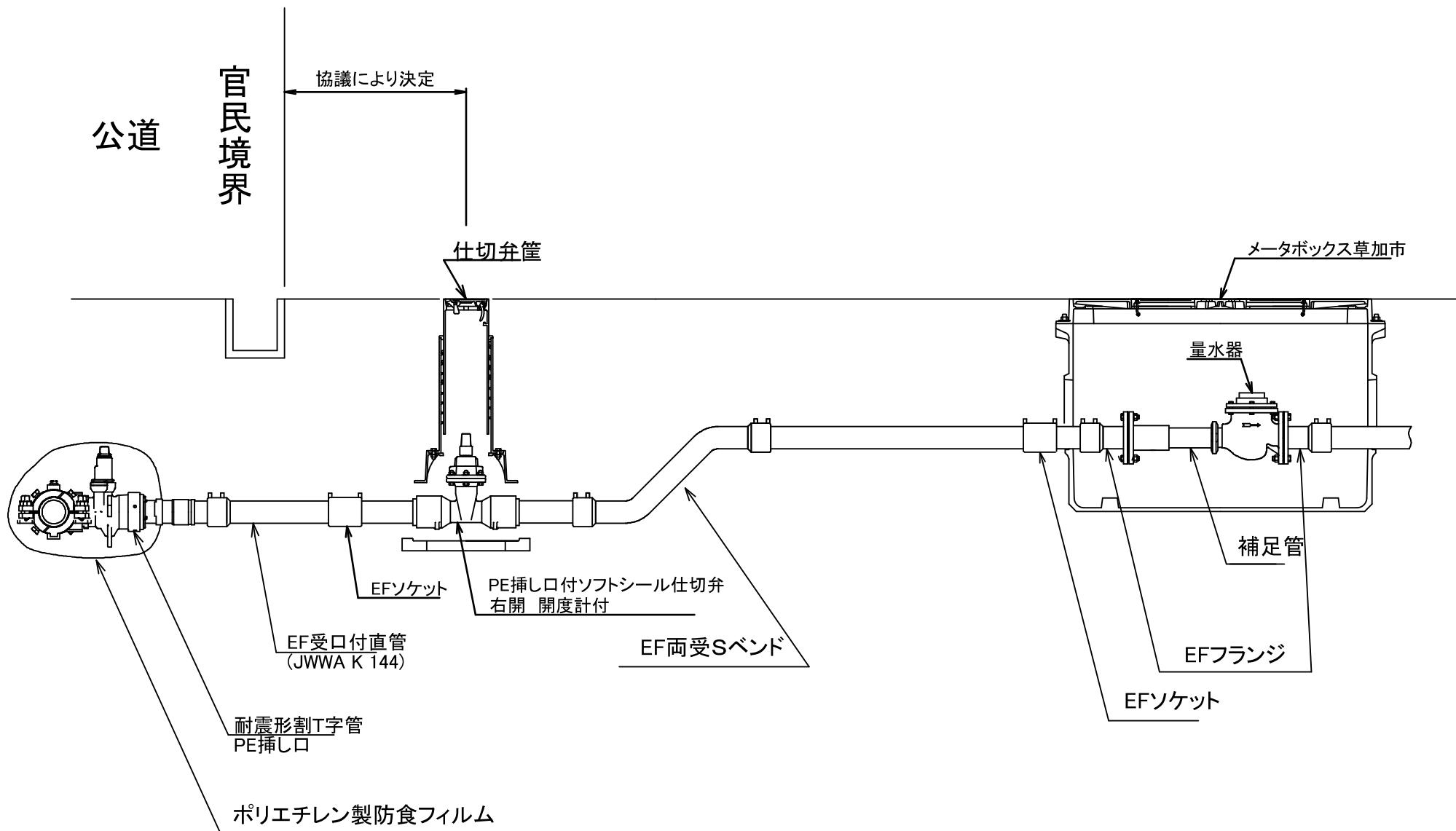
⑦ 本管:HPPE 引込み口径:Φ75・Φ100 メータ口径:Φ75・Φ100
