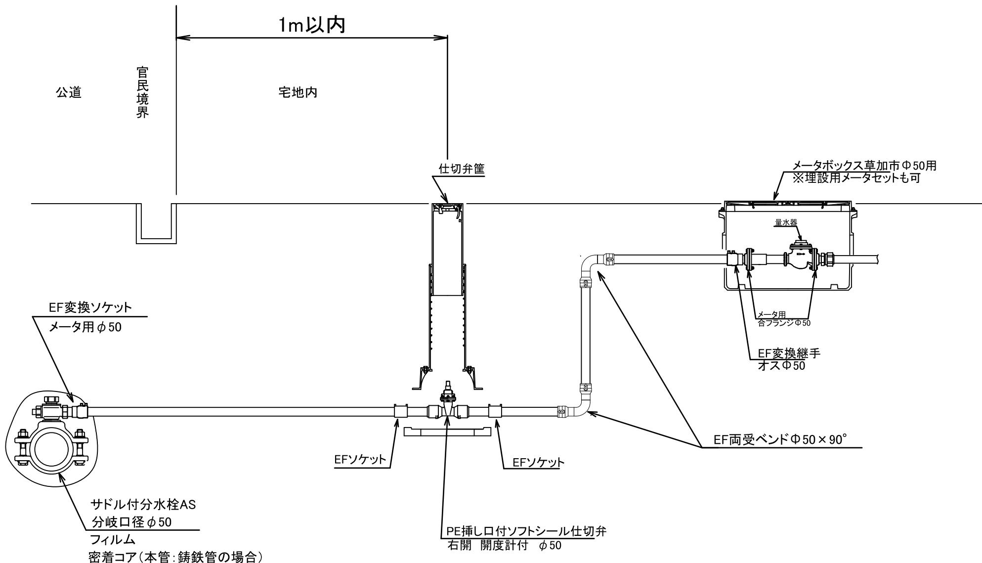
⑥ 本管: 鋳鉄管 引込み口径:  $\Phi 75$ ・ $\Phi 100$  メータ口径:  $\Phi 75$ ・ $\Phi 100$
